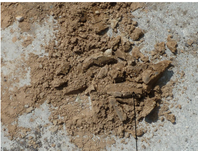
Bild 11: Der gewachsene Boden (Geschiebelehm), wurde in allen Bohrungen (mit Ausnahme von RKS 11) ab 0,70 m uGOK bis ca. 1,60 m uGOK angetroffen
