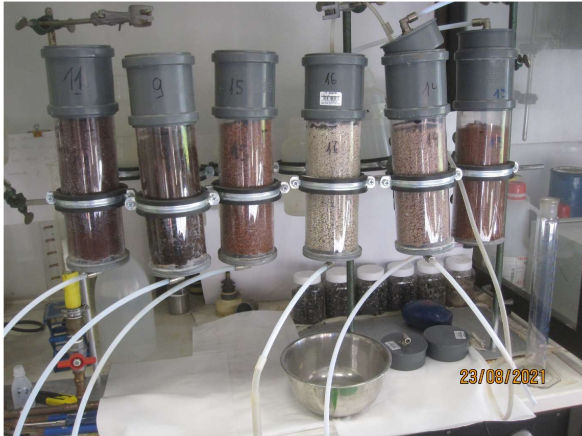
Abb. 1: Säulenversuche mit unterschiedlichen Mischungen
