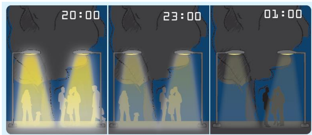
Abb. 21: Beispiel für eine gute Lichtabstrahlung und Reduktion der Leuchtdauer (StMUV 2020).
